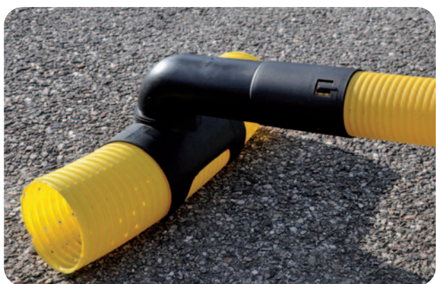
Le bouchage de drain sous colza est essentiellement dû à des défauts de réalisation du réseau qui gênent l'évacuation des débris végétaux. Le remplacement des anciens coudes pénétrants par des pipes de raccordement résout le problème.
